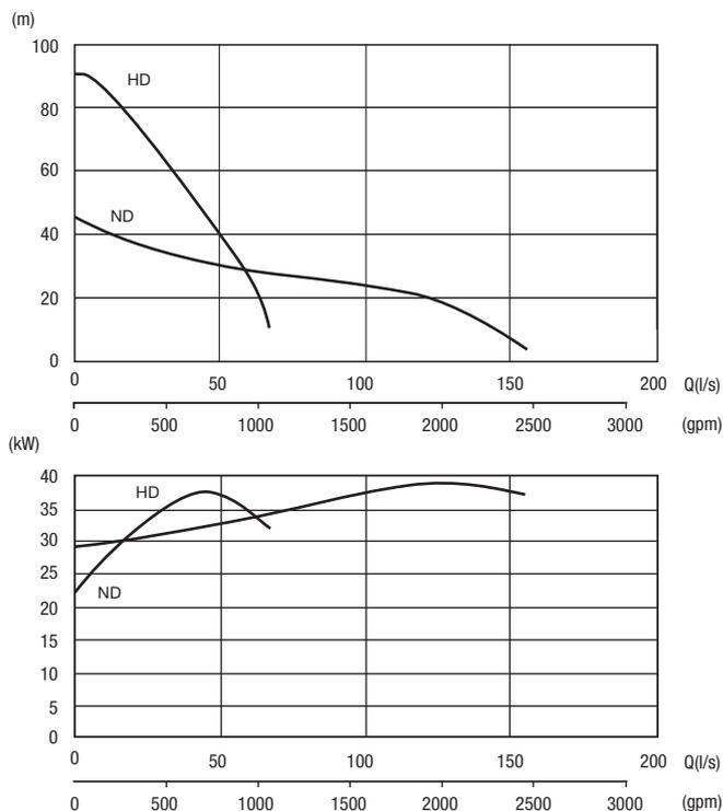
Bomba sumergible eléctrica para drenaje, fabricada en aluminio y acero inoxidable a prueba de ácidos. Para minas, plantas eléctricas y otras industrias que manejan aguas y sólidos abrasivos.
